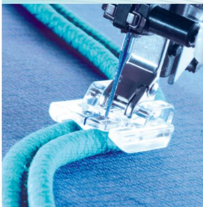
Zum gleichzeitigen Nähen von zwei Kedern mit dicken Kordeln. Für ausdrucksstarke Kantenverzierungen.
