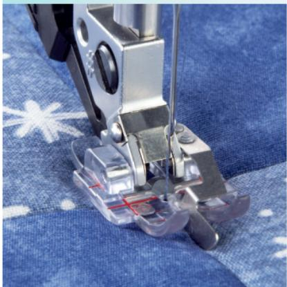
Für eine perfekte Sicht auf das Nähprojekt. Die Führung des Nähfußes folgt exakt der Mitte der Verbindungs nähte, sodass effektvolle Quiltnähte auf der Stoffoberfläche entstehen können.
