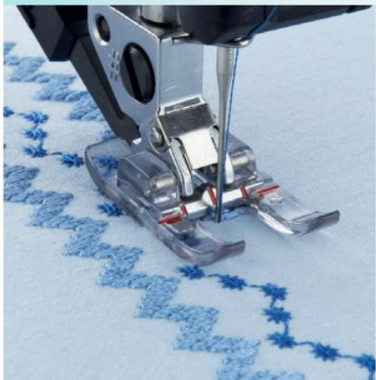
Zum Nähen von Applikationen. Die gute Sicht auf die Naht beim Nähen und die Aussparung für plastischere Stiche auf der Fußunterseite ermöglicht eine optimale Stichführung.
