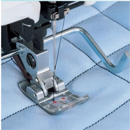
Platzieren Sie das Kantenführungslineal auf der gerade genähten Naht und nähen Sie eine weitere. Die Nähste werden dann exakt in dem von Ihnen gewünschten Abstand genäht.
