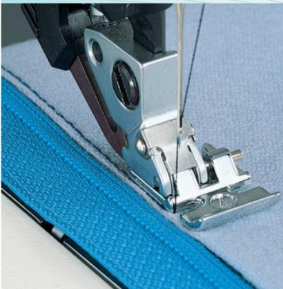
Zum exakten Einnähen eines Reißverschlusses an der Reißverschlusskante.
