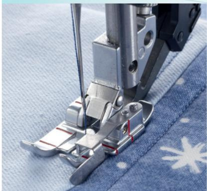
Zum exakten Nähen von Patchworkteilen oder Quilt-sandwiches. Die Kantenführung sorgt für einen perfekten Nahtabstand.
