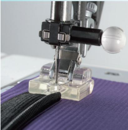
Zum komfortablen Einnähen eines nahtverdeckten Reißverschlusses.
